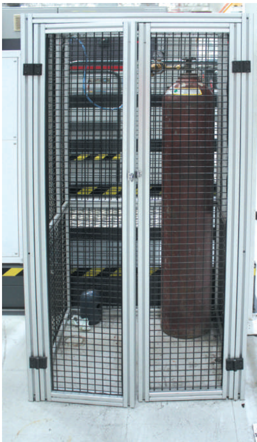
15 – Il gas (argon) con il quale si sublima il metallo target.
